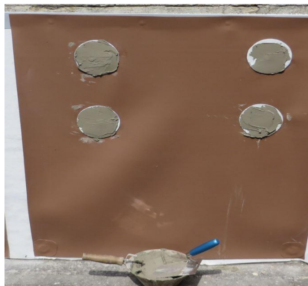
Obrázek č. 17: Aplikace lepicího tmelu ETICS na terče
