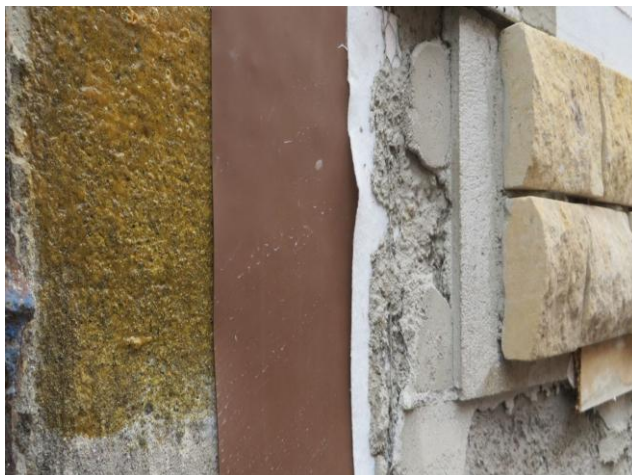
Obrázek č. 33: Boční pohled na skladbu soklové části vzorku ze zkoušky č. 3
