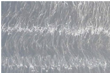
Správná aplikace lepidla = nános cca 30\text{ g/m}^2 v sušíně
