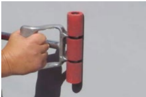
Stlačení lepených ploch ručním válečkem
