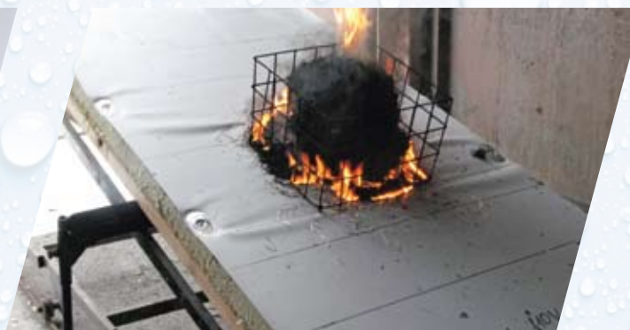
TESTOVÁNÍ FÓLIE NA STUPEŇ BROOF T1 NA PODKLADĚ Z MINERÁLNÍ VATY MEMBRANE TESTING TO BROOF T1 ON A MINERAL FIBER BOARD
