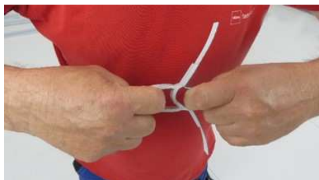
Obr. 12: Příklad provedení zkoušky odtržení profilu na zkušebním tělese
