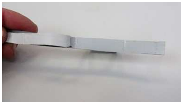
Obr. 14: Nedostatečná kvalita svaru – svar se rozlupuje
