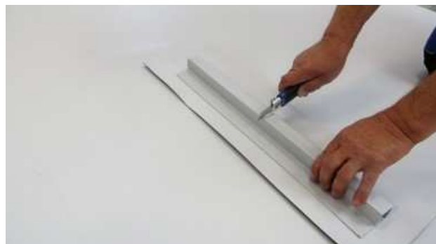
Obr. 10: Nařezání zkušebních těles pro zkoušku spoje v odtržení
