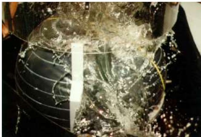
Obrázek 2: Protržení PVC-P fólie při max. průtažnosti
